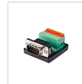
CS-99/M DB9(male) to 9 pin 터미널 블록
