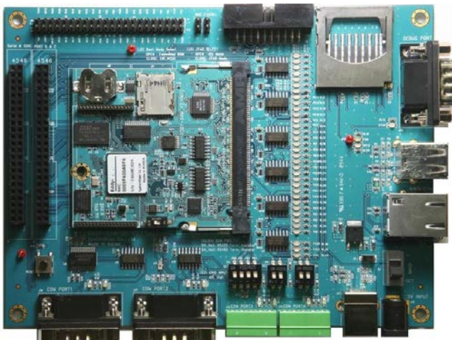
Development Kit Board 에 장착된 Eddy-S4M
