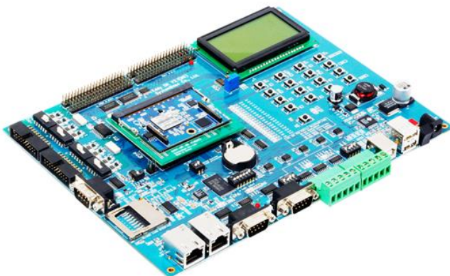
Development Kit Board 에 장착된 Eddy-CPU/mp
