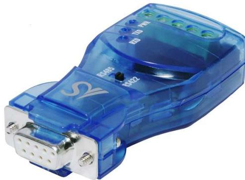
CS-428/9AT-ISO2는 RS 232 신호를 RS422 또는 485 신호로 변환해주는 컨버터입니다. 이 제품은 별도의 소프트웨어를 설치할 필요없이 DIP 스위치 조작으로 쉽게 RS422 또는 RS 485를 선택할 수 있어 사용이 간편합니다. 또한 3kV Isolation 기능을 탑재하여 외부에서 인 입 되는 서지로부터 고가의 장비를 보호할 수 있는 제품으로 산업용 온 습도를 지원하는 최고 사양의 산업용 컨버터입니다.
