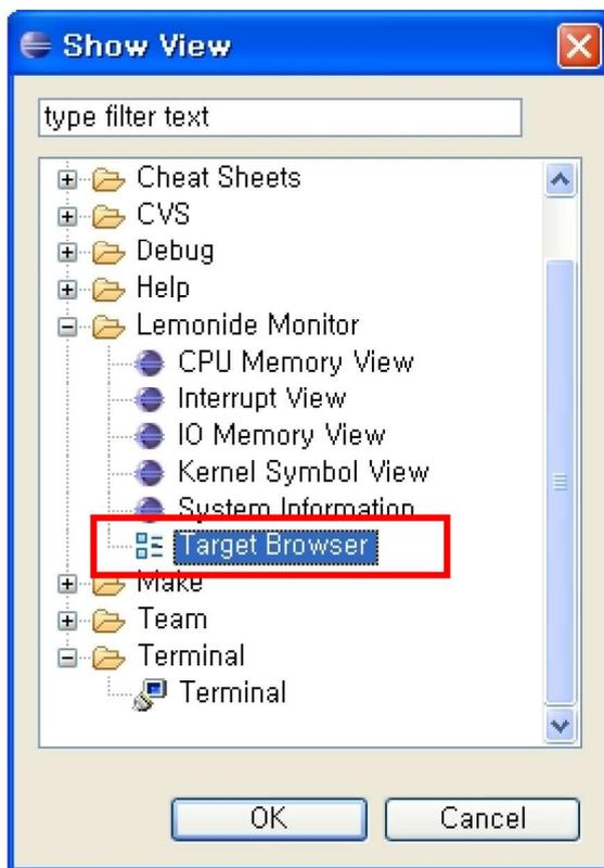
Target 브라우저에 원하는 Target이 없을 경우 Target을 추가해야 한다. Target 브라우저 우측에 파란색의 + 마크를 클릭하면 아래와 같은 Target 입력 윈도우가 나타난다. 이 곳에 Target의 이름, IP 주소, Target에 실행 중인 Target Agent의 포트 번호를 입력한다.
