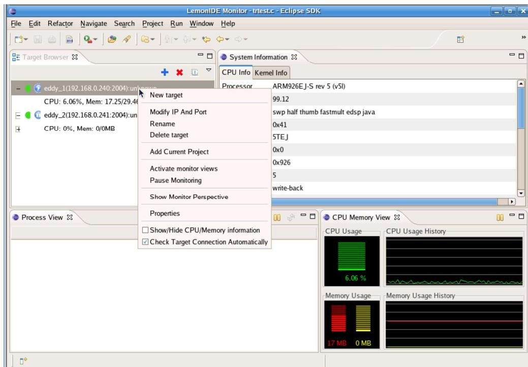
Hide CPU/Memory Information: 체크하지 않으면 Target 노드의 첫번째 서버 노드로 CPU와 메모리 사용량 정보가 표시된다. 단, 원격 모니터링 중이어야 실제 값이 표시된다. 이것은 Target 노드별로는 설정할 수 없고, 전체 Target 노드에 대해서 숨기거나 보여주게 할 수 있다.
