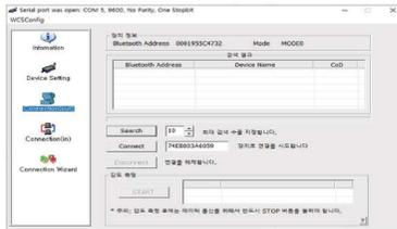
[Search]를 클릭하여 주변에 있는 블루투스 장치들을 검색합니다. 검색된 장치 중 하나를 선택하고 [Connect]를 클릭하면 해당 블루투스 장지로 연결을 시도합니다. 이때 상태바 블루투스 장치는 외부로부터 연결이 가능한 모드로 설정되어 있어야 합니다. 연결된 후 [START]를 눌러 링크 측정을 할 수 있습니다. [Disconnect]를 클릭하면 정상적으로 연결을 해제할 수 있습니다.
