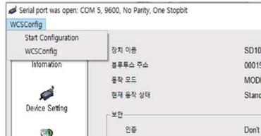
왼쪽의 Device Setting, Connection(out), Connection(in), Connection Wizard 아이콘을 클릭하면 각각의 해당 화면으로 넘어갈 수 있습니다. Device Setting 아이콘을 클릭하면 다음과 같이 각종 설정을 변경할 수 있는 화면이 나타납니다.
